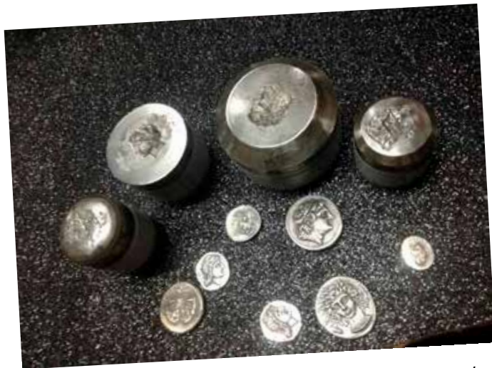
Μήτρες σκαλισμένες από το Λάμπη Κατσούλη, από τις οποίες κατασκευάζονται αρχαία νομίσματα κ.ά.
