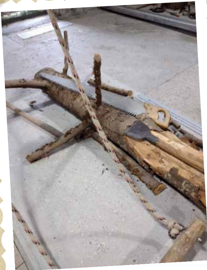
Το εργαλείο που χρησιμοποιείται για την αφαίρεση του φλοιού του κορμού, προκειμένου να ξεκινήσει η επεξεργασία του.
